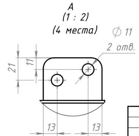
Габаритный чертёж гидрокомпенсатора.
